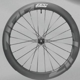
ha bisogno di sviluppare 286 watt per mantenere una velocità di 40kmh. Si tratta di 4 watt in meno a confronto con il modello precedente 404 Firecrest.
