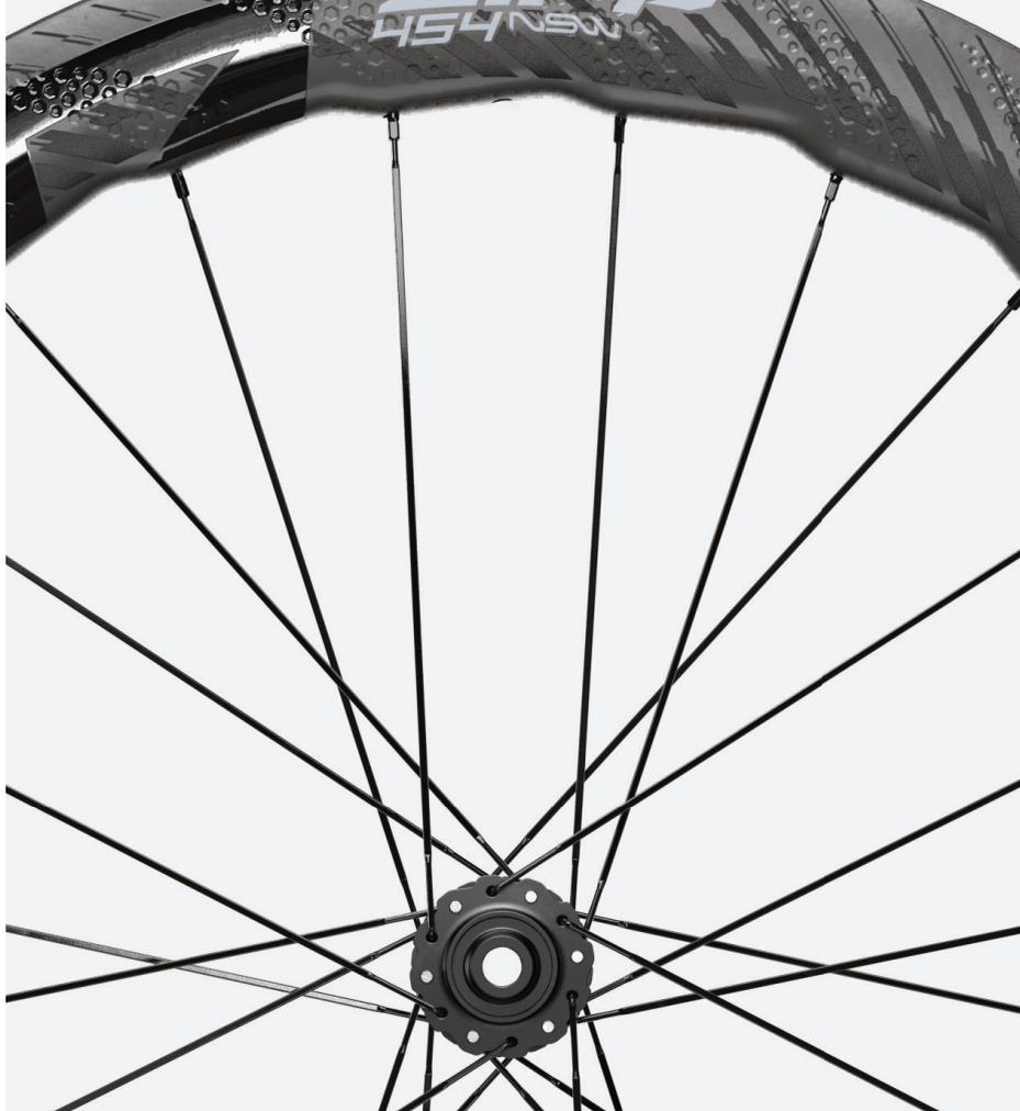
dell'Axial Clutch V2 serve a reingaggiare il meccanismo dei cricchetti velocemente e costantemente nel momento in cui si ricomincia a spingere sui pedali. I mozzi sono inoltre leggeri e resistenti.
